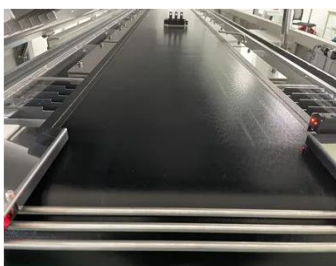
ワーク接触加熱方式ホットプレートリフロー
