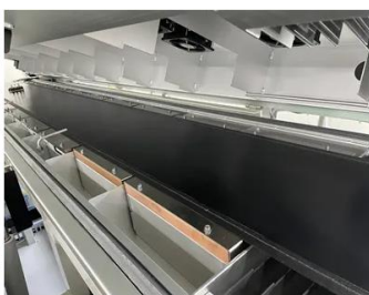
ワーク接触加熱方式ホットプレートリフロー
